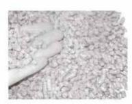
Le granulé de bois (sciure compressé sans liant). C'est un produit de qualité qui permet d'avoir une alimentation automatique dans un poêle ou une chaudière.  Le bois déchiqueté qui permet d'alimenter automatiquement une chaudière et qui, de ce fait, garantit une large autonomie.
